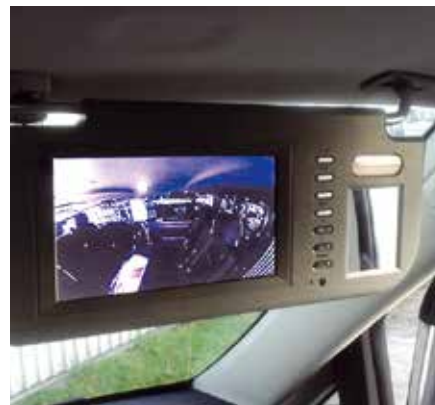
Innenraumüberwachung via Monitor.
